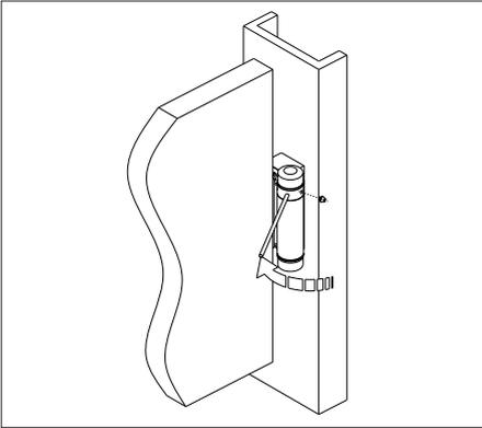
Verschrauben Sie das Pendeltürband exakt an Rahmen und Flügel der Tür und ziehen Sie die Befestigungsschrauben fest an. Beachten Sie, dass die Stell-Löcher **immer nach oben stehen**.
