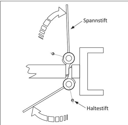
Öffnen Sie die Tür bis ca. 45° und stellen Sie diese fest. Nun spannen Sie mit dem beiliegenden Spannstift das Band **von rechts nach links (im Uhrzeigersinn)**. Ist die erforderliche Vorspannkraft erreicht, setzen Sie den Haltestift ein. Ist der Haltestift fest montiert, kann der Stellstift entfernt werden.
